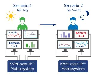
Beispiel für Tag-/Nacht-Szenarien: Mittels eines einzelnen Kommandos können alle für die Konsole benötigten Rechner der Tag- bzw. Nachtschicht aufgeschaltet werden.
