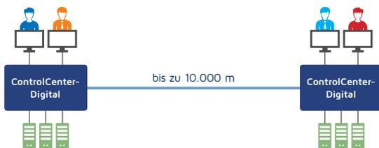
*Dank der bidirektionalen Verbindung werden im G&D KVM Matrix-Grid™ standortübergreifende Zugriffe möglich. Bei Anbindung mit Glasfaser können diese sogar mehrere Kilometer voneinander entfernt sein – und ergänzend zur klassischen Kaskade können nun die Anwender aller vernetzten Standorte auf alle angeschlossenen Systeme zugreifen.*
