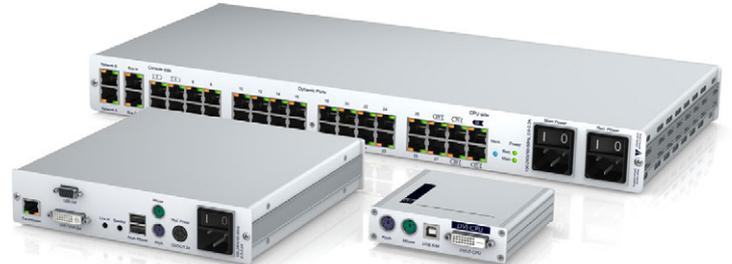
Die Signalübertragung erfolgt über CAT-Kabel und/oder Lichtwellenleiter. Der ControlCenter-Compact steht in der Variante als 80C, 64C, 48C, 32C, 16C, 16F, 16F16C und 8C zur Verfügung. Jeder einzelne Port des ControlCenter-Compact kann wahlweise für die Nutzung als Verbindung zu einem Rechnermodul oder einem Arbeitsplatzmodul eingesetzt werden. Dank dieser Dynamic-Port-Technologie kann das System sehr flexibel an die bestehenden Kundenanforderungen angepasst werden.
